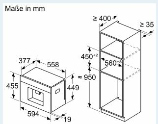
Bohnen- und Wasserbehälter werden von vorne entfernt Empfohlene Installationshöhe 950-1450 mm
