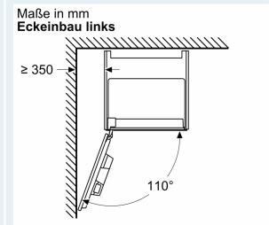
Bei Verwendung des 92°-Scharnierbegrenzers beträgt der min. Abstand zur Wand nur 100 mm
